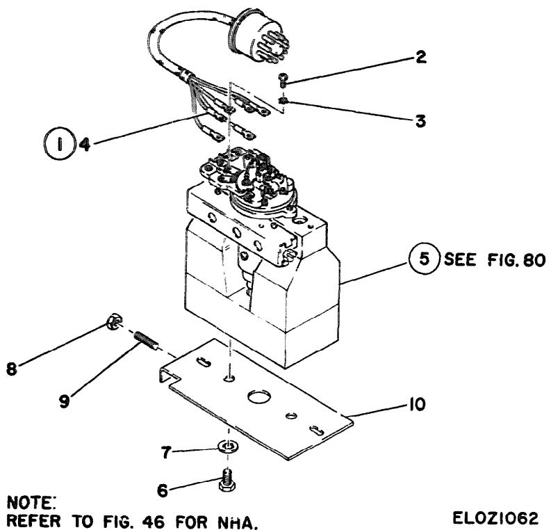
Figure 62 Galvanometer subassembly
